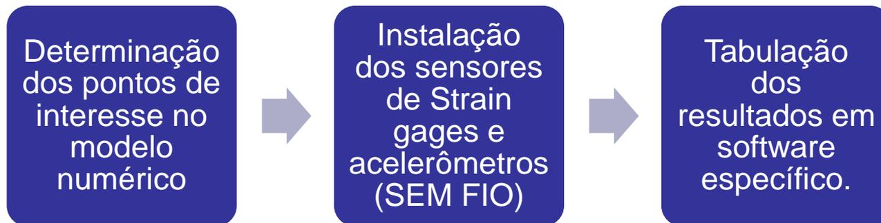
**Com esta metodologia elimina-se as extrapolações de ciclos (“chutes”) e a previsão de vida útil a fadiga torna-se mais próxima a realidade estrutural.**
