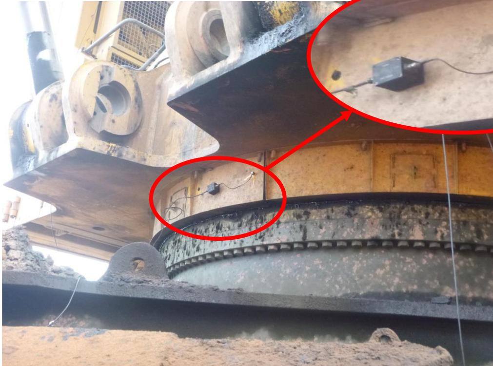
Os sensores e pré amplificadores possuem base magnética para fixação durante o ensaio.
