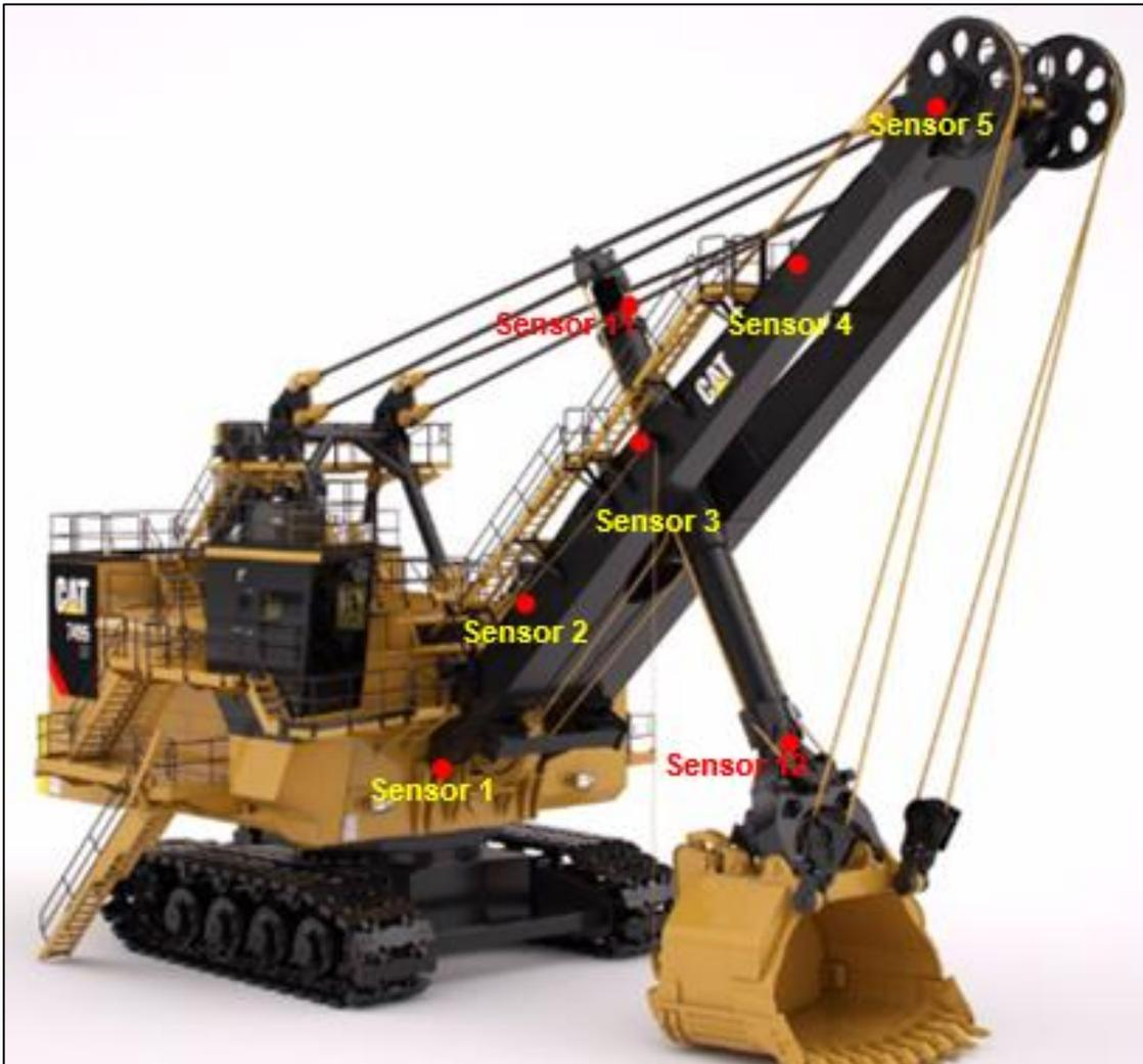
As localizações dos sensores para ensaio foram determinadas pela configuração do objeto do ensaio, particularidades estruturais nas regiões críticas e acesso para fácil instalação sem intervenções de desmontagem de componentes mecânicos.
