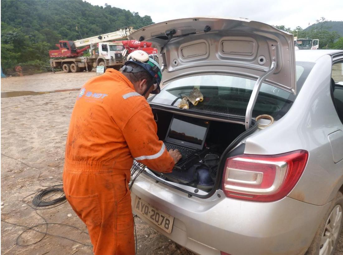
A IB-NDT possui protetores eletrônicos que permitem a alimentação elétrica do sistema de Emissão acústica diretamente da bateria de veículo automotivo facilitando a logística de inspeção junto ao cliente
